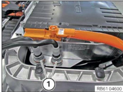
使用工具套件 2413106 中的喷嘴 11x 20 密封带盖 1 冷却液接口，以免与模块连接器接触。
